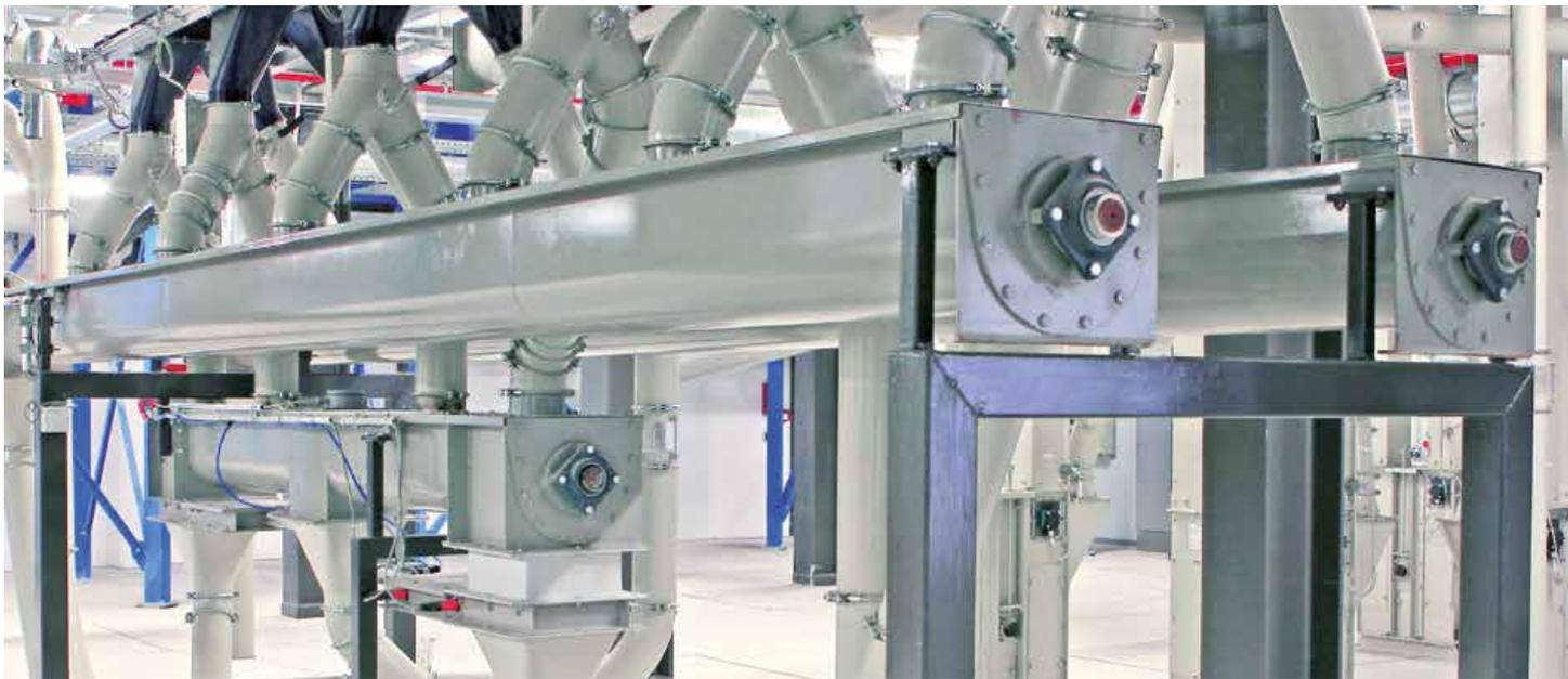
Tanto la versión de un eje como de varios ejes, los tornillos sin fin de artesa de TRENNSO-TECHNIK se distinguen por su alto rendimiento de transporte, su gasto reducido de mantenimiento y sus bajos costes de explotación. El rendimiento de descarga de los elementos de transporte se puede regular sin escalones, si así se desea.
