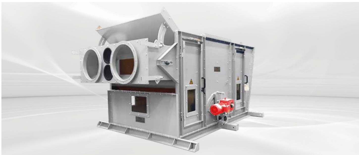
Durante este proceso el material con mayor densidad desciende por la mayor fuerza de gravedad hacia abajo y se extrae a través de la salida. Los productos de peso medio se desvían mediante la corriente de aire dirigida horizontalmente y se extraen en la salida correspondiente. El material ligero lo transporta la corriente de aire y se extrae por la aspiración.
