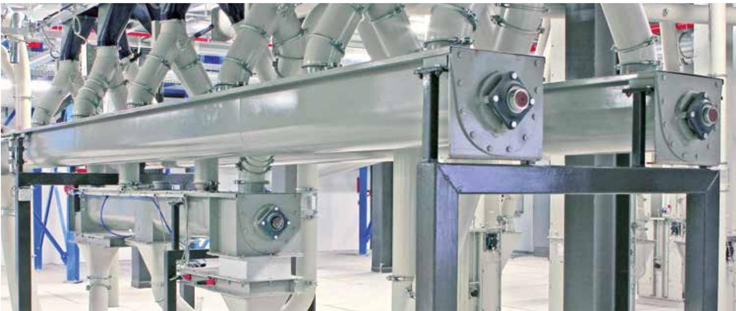
Ob ein- oder mehrwellig, die Trogschnecken von TRENNSO-TECHNIK® überzeugen durch hohe Förderleistungen, einem geringen Wartungsaufwand und niedrigen Betriebskosten. Die Austragsleistung der Fördererlemente lässt sich auf Wunsch stufenlos regeln.
